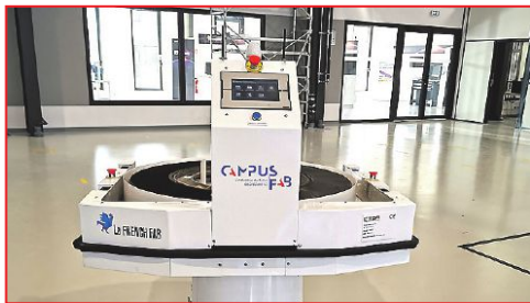
Le robot qui transporte les pièces du magasin aux différents pôles.
